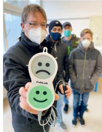
**Ampeln zur Messung des CO<sub>2</sub>-Gehalts in der Luft.**
